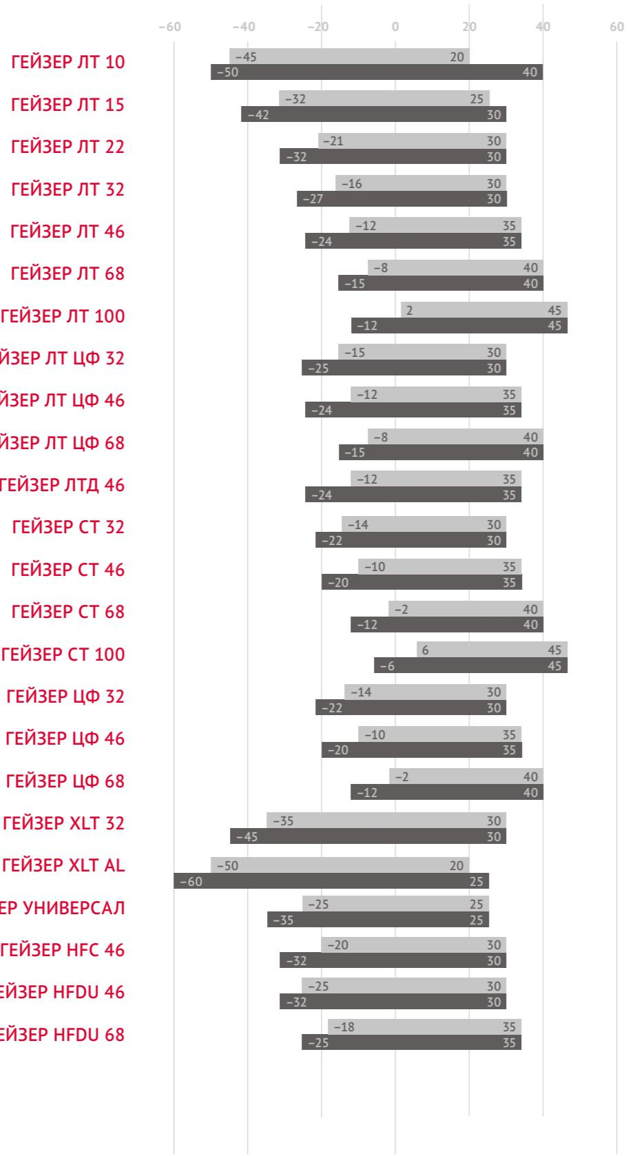
● Диапазон рабочей температуры для аксиально-поршневых насосов
