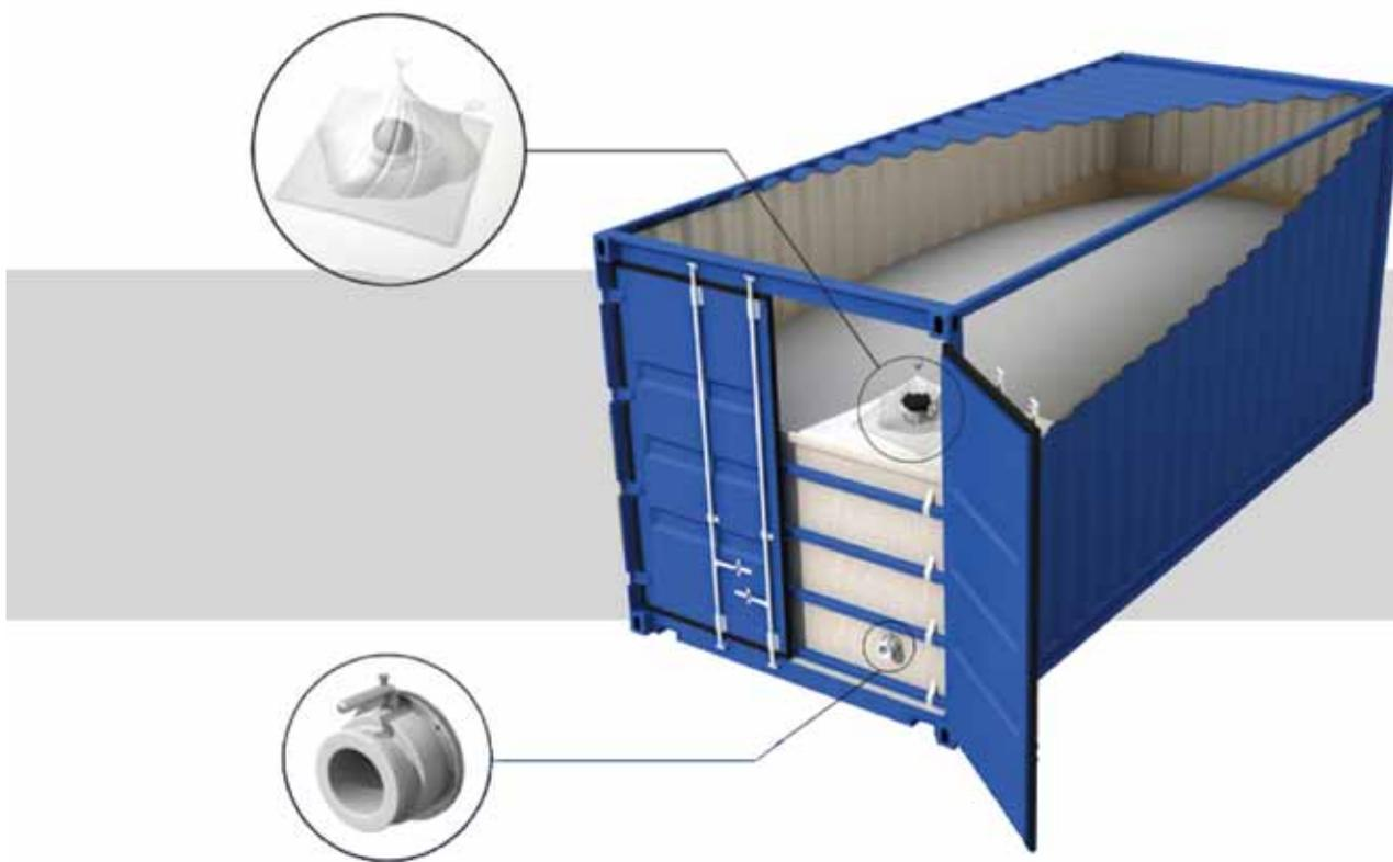
ФЛЕКСИТАНКИ ХАРАКТЕРИЗУЮТСЯ ВЫСОКИМ УРОВНЕМ БЕЗОПАСНОСТИ, ОБЕСПЕЧИВАЕМЫМ ПЯТИСЛОЙНЫМ ИСПОЛНЕНИЕМ МЕШКА.
